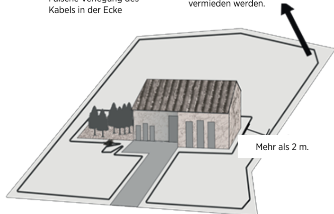
Richtige Verlegung des Kabels in scharfen Ecken
